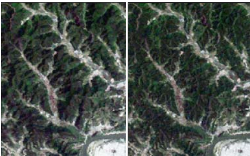
(a) 원 영상 (b) 1차 지형 정규화 이후 < 부록그림 II-3 > 1차 지형정규화 이전과 이후의 영상의 밝기값 변화
