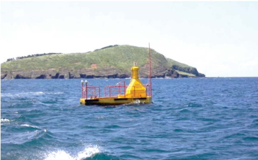
그림2. 등부표용 부유식 소형파력발전기
